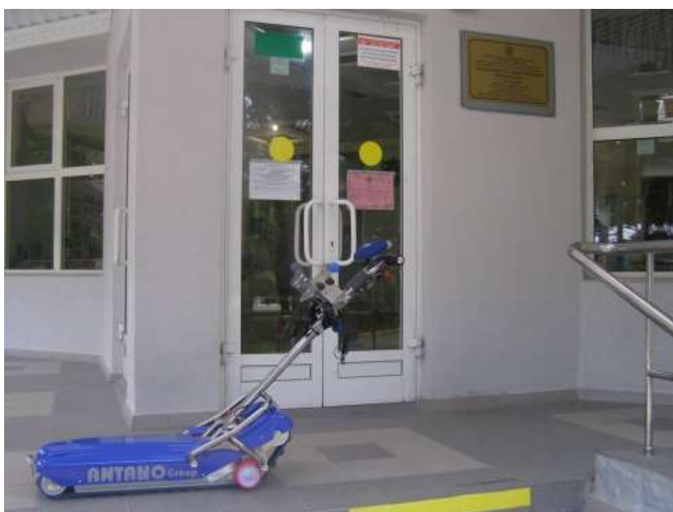
Гусеничный подъемник для инвалидов LG 2004 для беспрепятственного передвижения по лестнице
